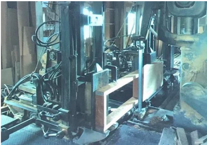
厚板から薄板を製材する方法
